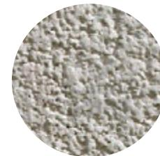
Concreto blanco: sus propiedades son parecidas a las del concreto gris. Está compuesto por cemento blanco, agua y áridos y aditivos. Se usan principalmente en edificios que quieran dejar este material sin recubrimientos.
