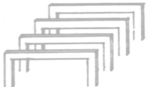
Pórticos: en concreto reforzado que puestos uno detrás del otro, que funcionan con columnas y vigas, siendo las primeras las que transmiten la carga a los cimientos.
